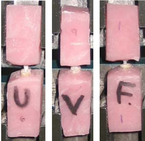
Imagen # 10. Confección de otro troquel con las mismas medidas del troquel base, el cual se sujeta al endoposte con acrílico rosado de autocurado.
