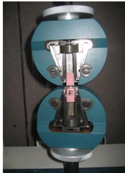
Imagen # 13. Colocación de las muestras en las bases del tensómetro
