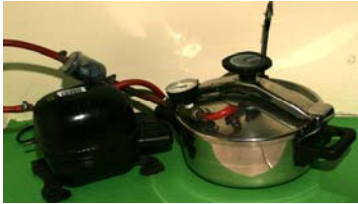
Figura # 28. Máquina generadora de vacío diseñada por los Drs. Brenes Ditel y Stedem Obando. Fuente: Ulate, R. 2006.
